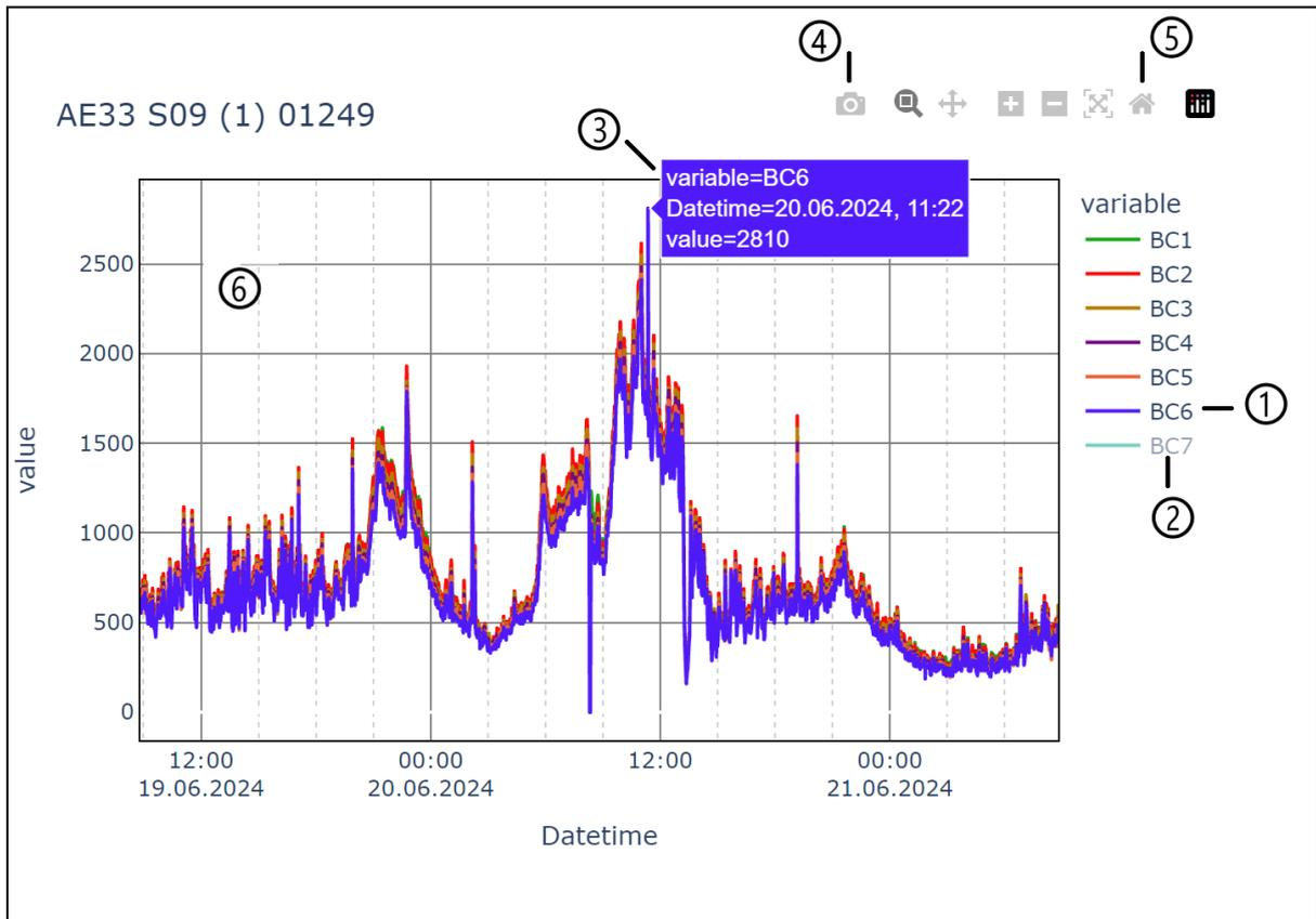
**Рисунок 19. Описание графика.** 1 — Видимый параметр (нажав на него можно сделать скрытым); 2 — Скрытый параметр (нажав на него можно сделать видимым); 3 — Параметр в данной точке (при наведении на точку); 4 — Возможность сделать снимок png; 5 — Вернуть оси в изначальное состояние или двойное нажатие на график; 6 — Можно менять масштаб графика, выделив определенную область ЛКМ; 7 — Двойное нажатие по параметру оставляет только его на графике.
