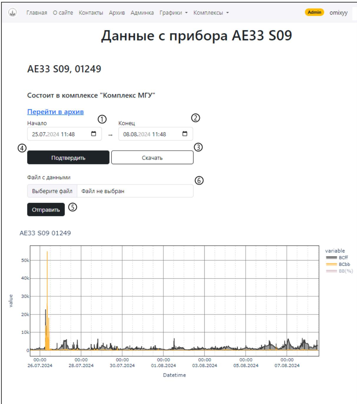
**Рисунок 4. Страница прибора на примере AE33 S09-01249.** 1 — Начало и 2 — конец измеряемого промежутка; 3 — Скачать csv-файл с данными по выбранному промежутку на компьютер пользователя; 4 — Применить выбранный промежуток времени к графику; 5, 6 — Форма отправки на сервер и выбор пользовательского файла; 7 — Доступные для отображения ряды данных с прибора.
