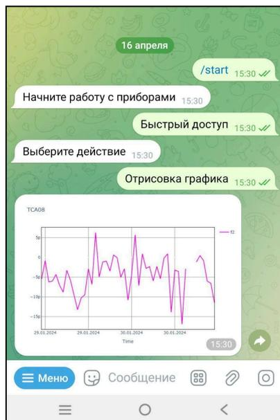
**Рисунок 9.** Пример получения графика данных прибора TCA08 с предварительными настройками.
