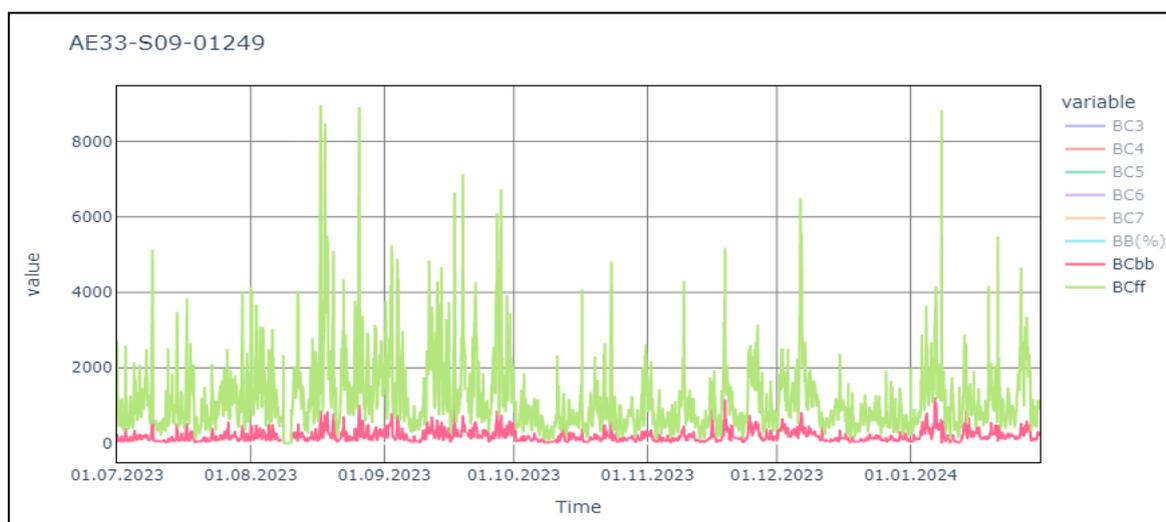
**Рисунок 2.** График параметров BCbb и BCff, измеренных с помощью анализатора сажи в воздухе AE33-S09-01249.
